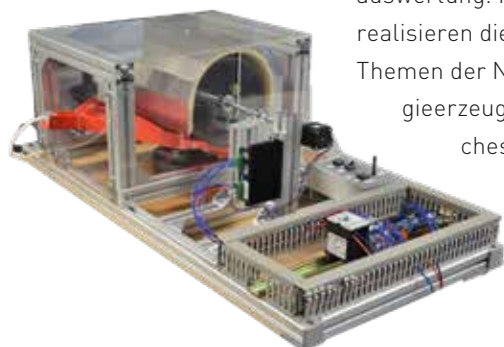
Bild: Entwicklung eines Latentwärmespeichers mit rotierender Wärmeübertragerfläche im Rahmen der interdisziplinären Projekte.
