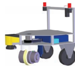
Abbildung 2: Testaufbau zur Erprobung des Antriebsmoduls
