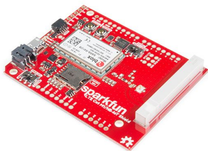
Abbildung 1: SparkFun LTE CAT M1/NB-IoT Shield mit SARA-R4 Modem
