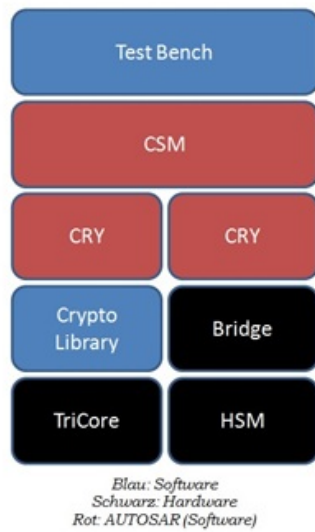
Abbildung 2: Software- und Hardware-Schichten-Architektur der Arbeit
