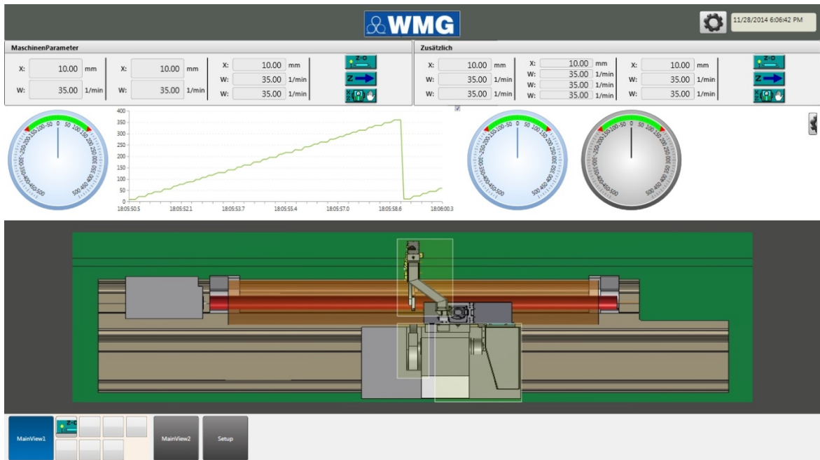
Abbildung 2: Abbildung 2 : Entwurf einer benutzerfreundlichen GUI am Bsp. Walzenschleifmaschine
