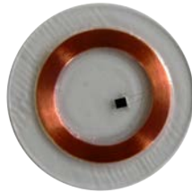
Abbildung 2: RFID-Transponder: Spule mit Chip
