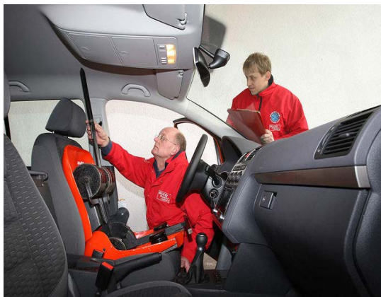
Abbildung 1: Bestimmung des Raumangebotes für den Fahrer mittels Messpuppe
