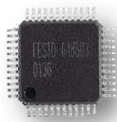
Abbildung 1: CBUS-ASIC von Festo
