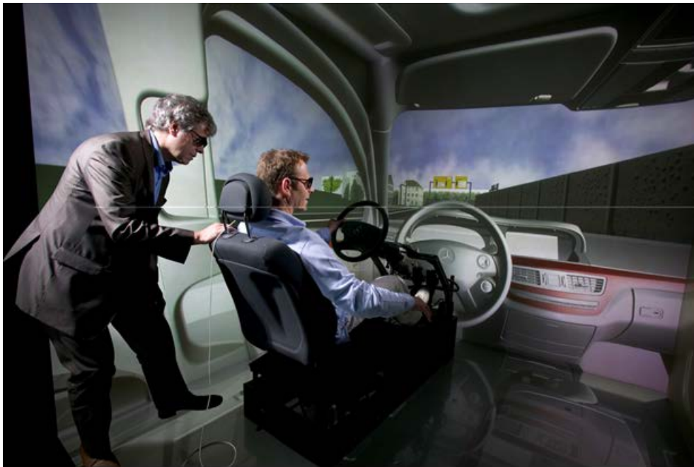
Abbildung 3: Virtuelle Fahrklausur im Virtual Reality Studio mit einem „MixedMockUp“. Sitz und Lenkrad sind hier real, Interior, Cockpit und Fahrzeugumgebung werden virtuell visualisiert.
