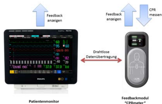
Abbildung 1: erweitertes Echtzeit-Feedback-System: Das Feedbackmodul misst die ausgeführte CPR und überträgt die Daten drahtlos an den Patientenmonitor. Beide Geräte stellen das Feedback visuell dar.
