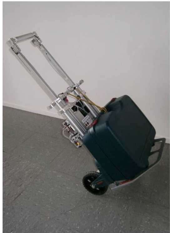
Abbildung 1: Lastensystem stabilisiert mittels Segway-Prinzip
