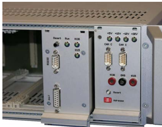
Abbildung 1: Links ein PIM und rechts die Versorgungseinheit des Racks
