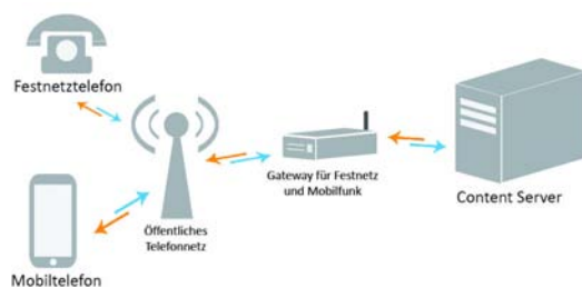
Abbildung 1: Funktionsweise eines Anrufs über den Content-Server.
